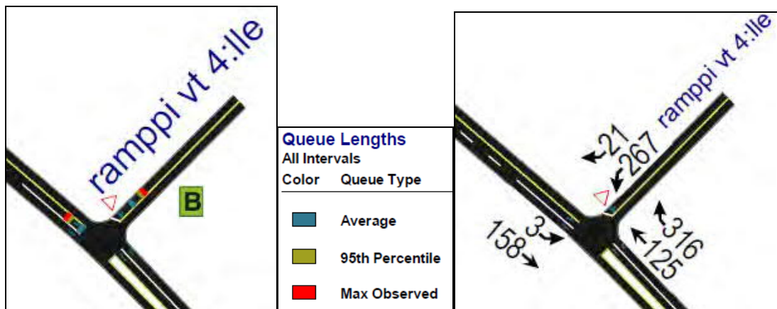
Kuva 5. Vt 4 rampin ja Sukurantien liittymän jononpituudet ja liikennemäärät sekä rampin palvelutasoluokka kesän 2010 iltahuipputunnin aikana.
